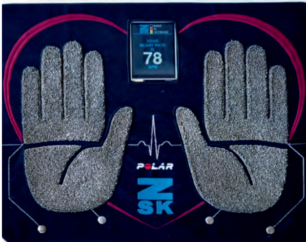
Abb. 4: Demonstrator zur Herzfrequenz-Messung mit moosgestickten Elektroden (Quelle: ZSK Stickmaschinen GmbH).
