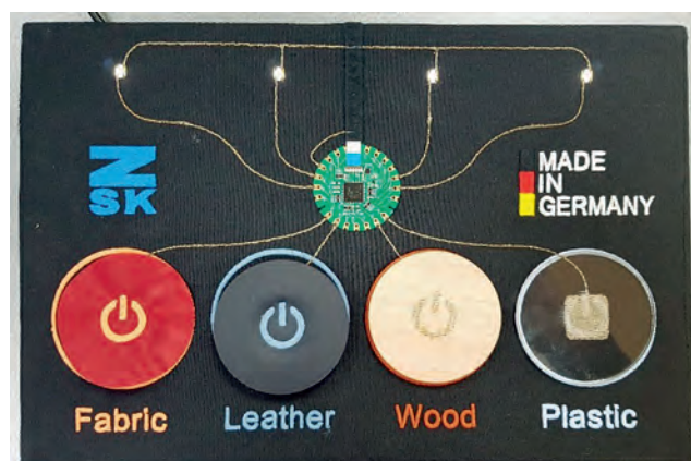
Abb. 2: Demonstrator mit sticktechnisch integrierten LEDs, Sensorflächen, Leiterbahnen und Platine zur Bedienung von kapazitiven Touch-Sensoren, die durch Textil, Leder, Holz und Plexiglas hindurch betätigt werden können (Quelle: ZSK Stickmaschinen GmbH).
