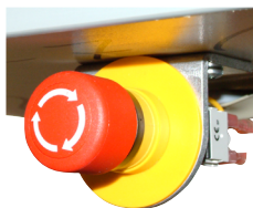
Obrázek 4: Nouzové tlačítko Vlevo: neaktivované
