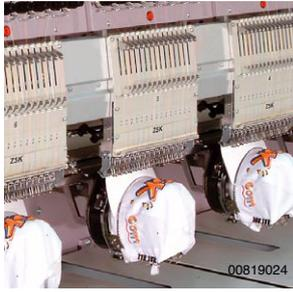
Die ZSK-Kappeneinrichtung ermöglicht das Besticken von konfektionierten Kappen oder Mützen.
