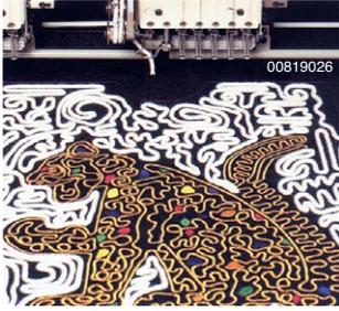
Die ZSK-Doppelrollen-Kordeleinrichtung zeichnet sich dadurch aus, dass sie dickere, runde, elastische und nicht zu harte/steife Kordeln bis zu einer Stärke von 4 mm verstickt und diese dem Stickgut spannungsarm zuführt.
