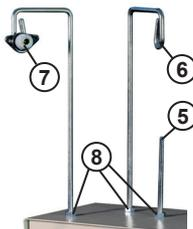
Schrauben Sie den Garnkonenhalter (5) und die beiden Fadenführer (6), (7) einige Umdrehungen in die Gewindebohrungen auf der Oberseite des Spulers.
