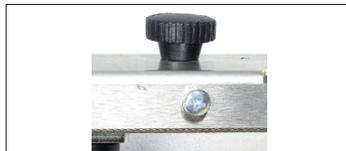
Abb. 26: Kappeneinrichtung, Standardbefestigung
