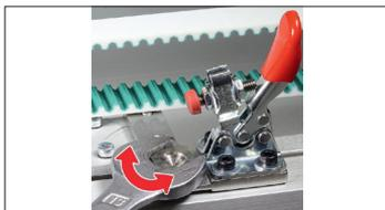
Stellen Sie mittels eines geeigneten Schraubenschlüssels an den Zentrierungen die Aufnahmekraft des Systems ein, mit welcher der Bordürenrahmen in die Führungen gedrückt werden soll.
