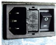
⇒ Sicherungsfassung wieder eingebaut und verriegelt.
