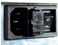
⇒ Die Sicherungsfassung springt etwas aus dem Gehäuse heraus.
