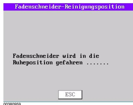
=> Nach Erreichen der Ausgangsposition der Fadenschneidermesser wird auf dem Bildschirm das Menü „Service“ wieder eingeblendet.
