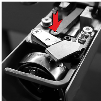
Abb. 9: Freiarms, Schmierstellen der Zugstange
