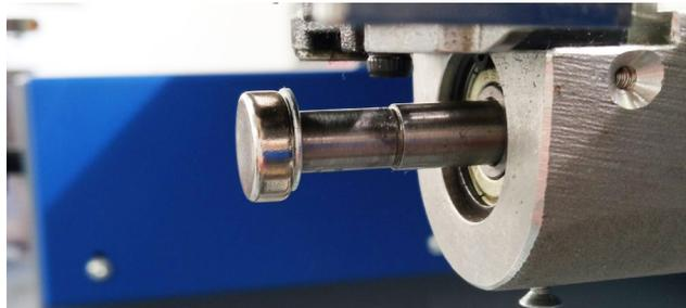
**Schritt 4:** Drücken Sie jetzt über die Buchse die Pickerstange nach vorne bis Sie merken, dass die Pickerstange am Magneten anliegt und fixieren diese mit dem Gewindestift.
