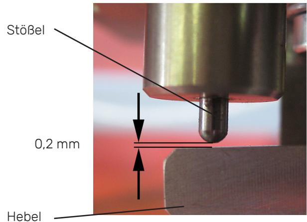
**Schritt 6:** Nach Einbau von Greifer und Haltefinger an der Maschine, darf sich der Picker (im Test Diagnose Programm aktiviert) über den Hebel nicht mehr weiter nach vorne drücken lassen, sondern muss spielfrei sein.
