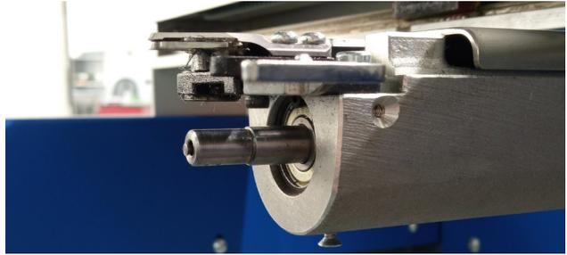
**Schritt 5:** Jetzt kann der Picker-Magnet so eingestellt werden, dass der Abstand zwischen Stößel und Hebel in der Ruheposition 0,2 mm beträgt. Dazu verschieben Sie den Magneten über die zwei Stellschrauben.
