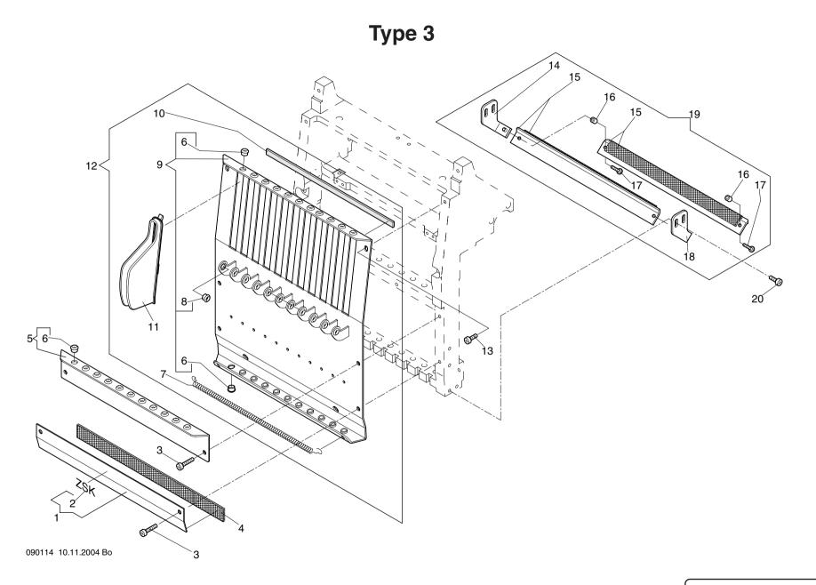
Maschinentype: Flachbettstickmaschine SCF Baugruppe: Front panel type 3 - Stirnblech Typ 3
