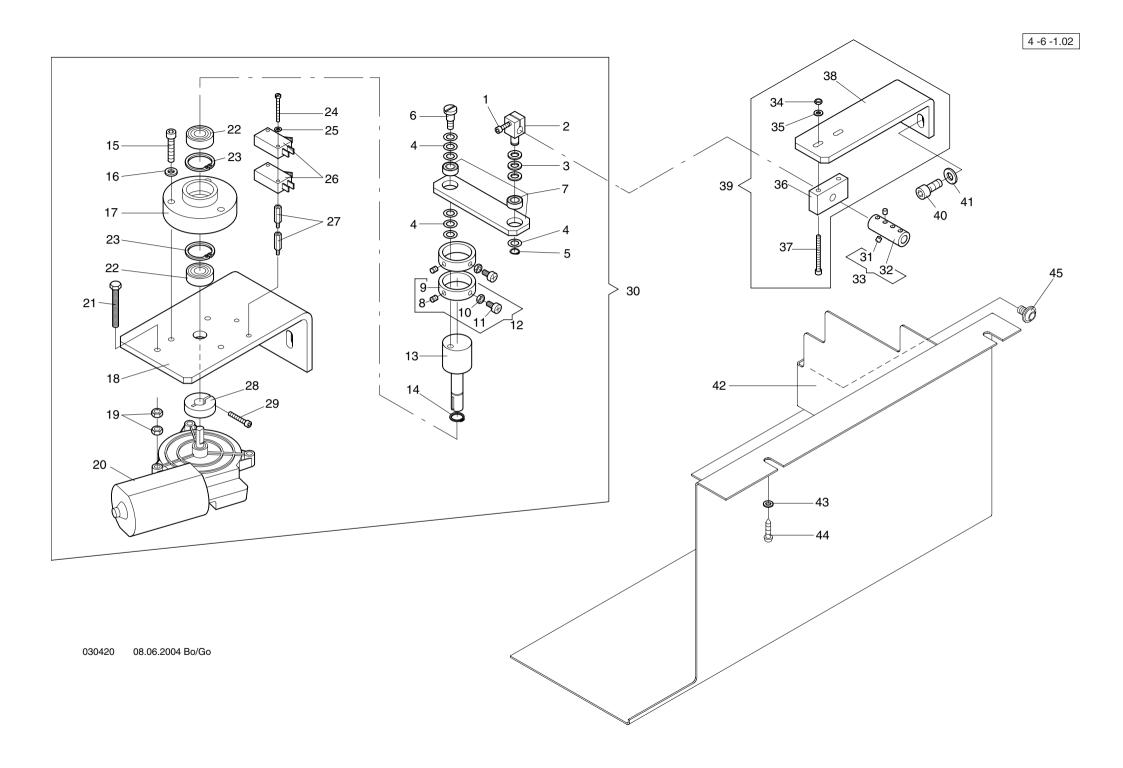
Maschinentype: Flachbettstickmaschine Baugruppe: Thread trimmer drive - Fadenschneiderantrieb SCF
