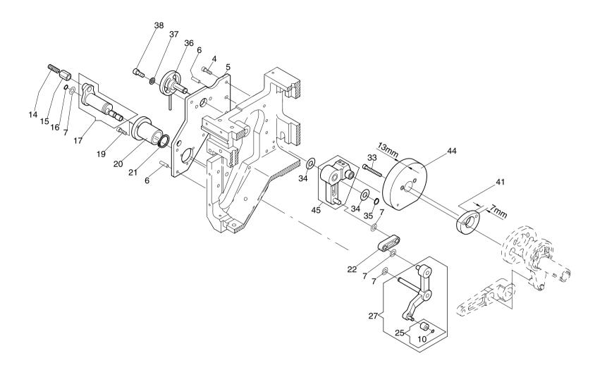
Flachbettstickmaschine SCF Baugruppe: Cushioned presser foot - Stoffdrücker-Abfangeinrichtung
