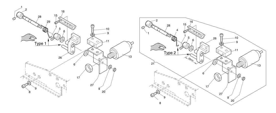
Flachbettstickmaschine SCF Baugruppe: Jump stitch device - Springsticheinrichtung
