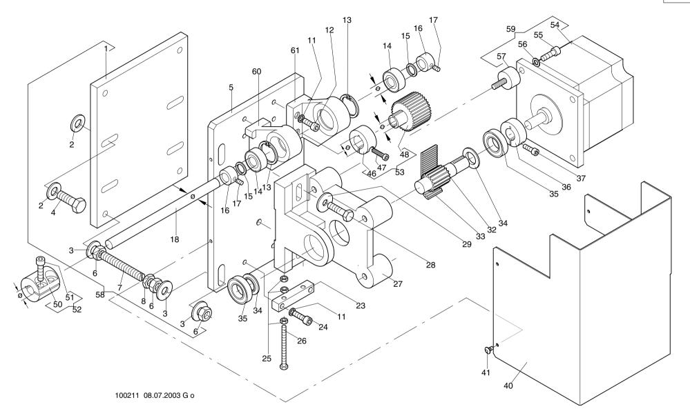
Flachbettstickmaschine SCF Baugruppe: Pantograph drive motor for side movement - Pantograph-Antriebsmotor für Seite
