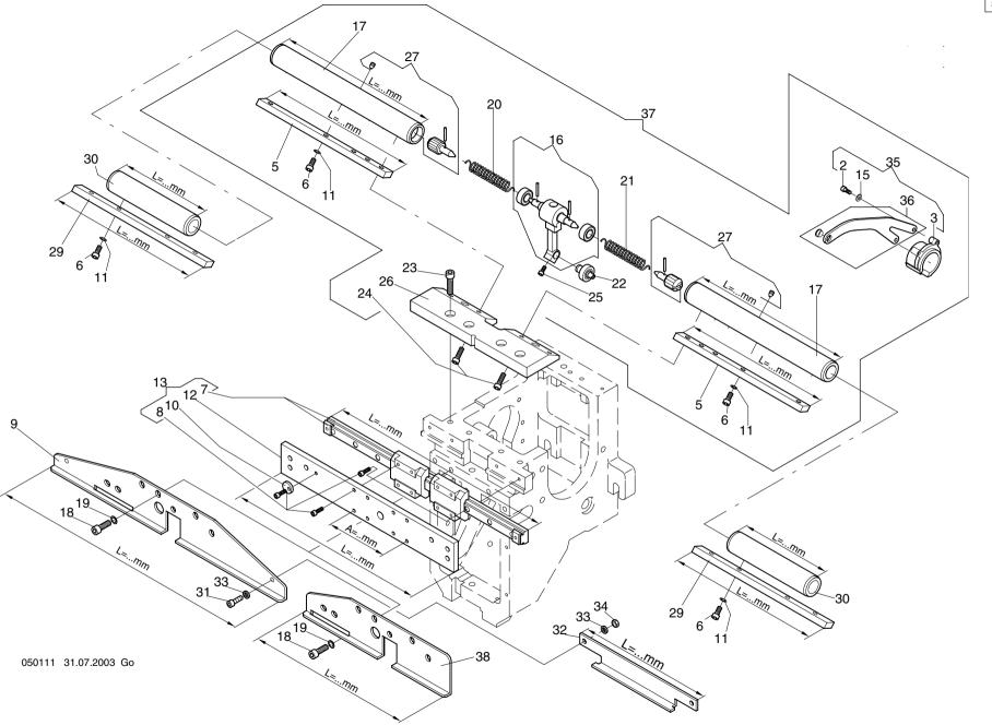
Baugruppe: Thread take-up - Fadengeber Flachbettstickmaschine SCF
