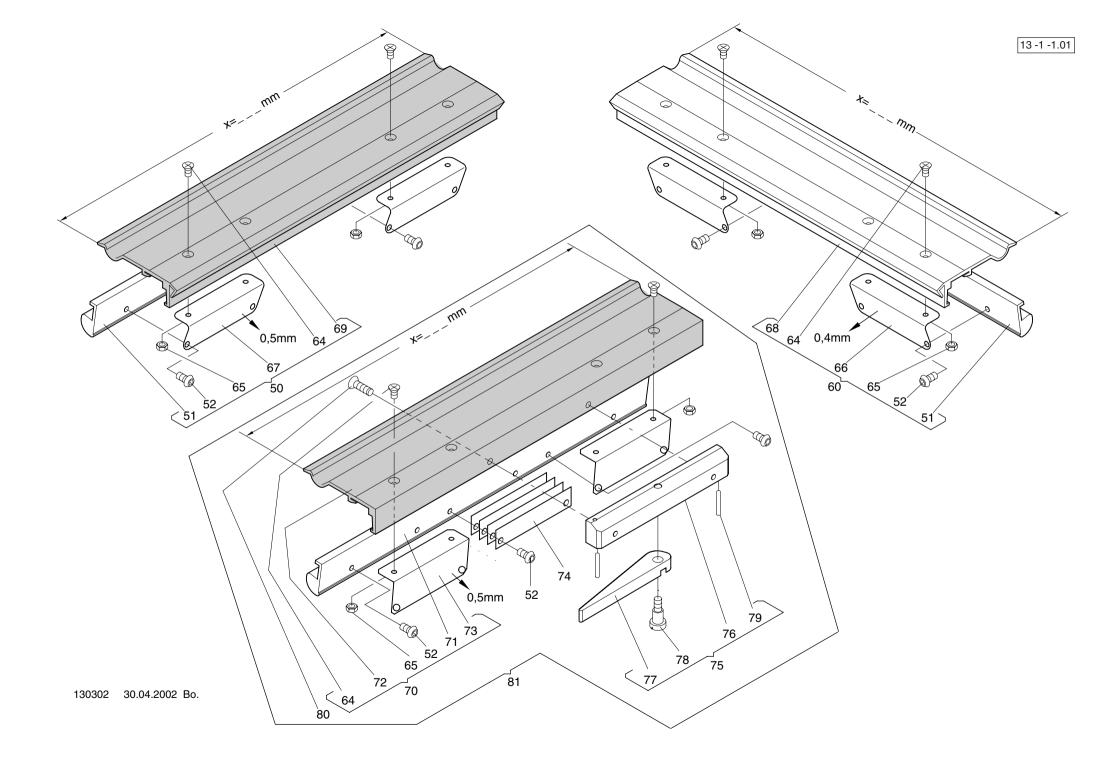
Flachbettstickmaschine SCF Baugruppe: Clamping element - Bordürenspanner
