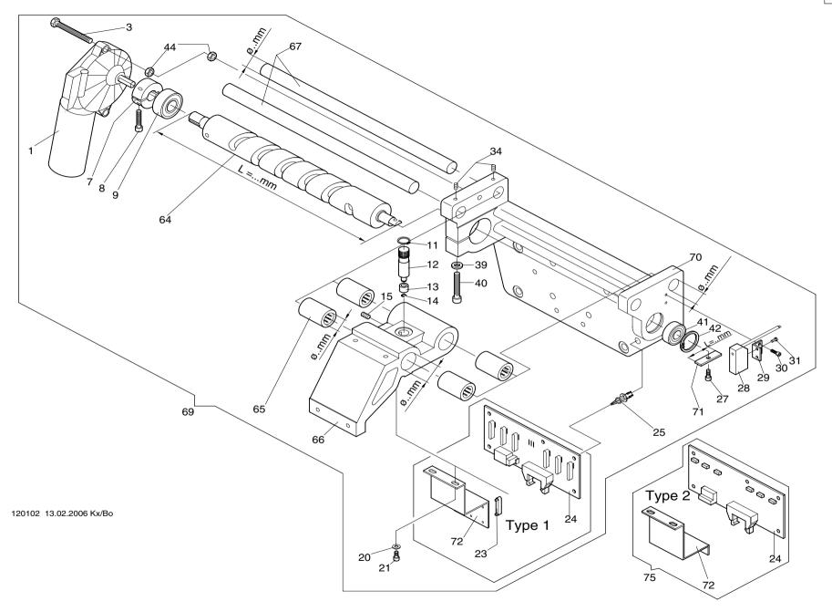
Flachbettstickmaschine SCF Baugruppe: Color change device - Farbwechseleinrichtung
