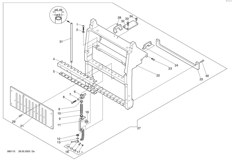
Baugruppe: Needle block - Nadelblock Flachbettstickmaschine SCF
