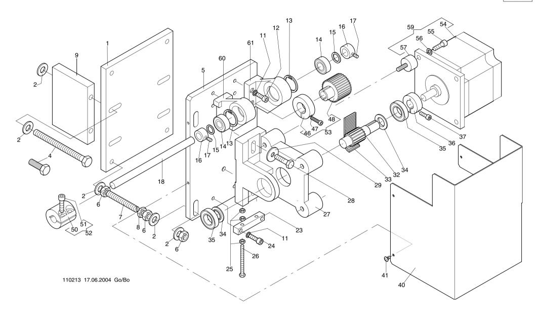
Maschinentype: Flachbettstickmaschine Baugruppe: Pantograph drive motor for depth movement - Pantograph-Antriebsmotor für Tiefe SCF
