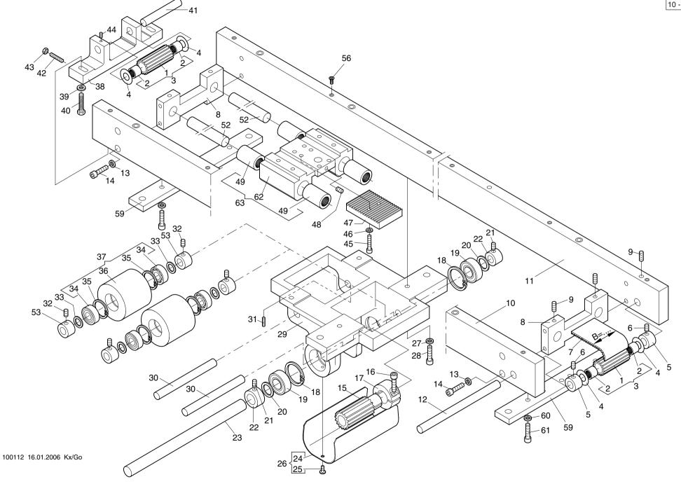
Flachbettstickmaschine SCF Baugruppe: Pantograph drive 1+2 for side movement - Pantograph-Antrieb 1+2 für Seite
