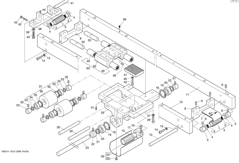
Flachbettstickmaschine SCF Baugruppe: Pantograph drive 3 for side movement - Pantograph-Antrieb 3 für Seite
