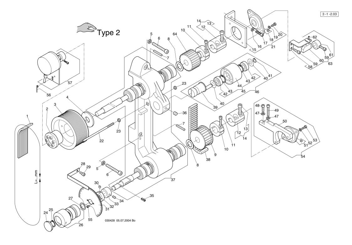
Flachbettstickmaschine SCF Baugruppe: Driving shaft above/below type 2 - Antriebswelle oben/unten Typ 2
