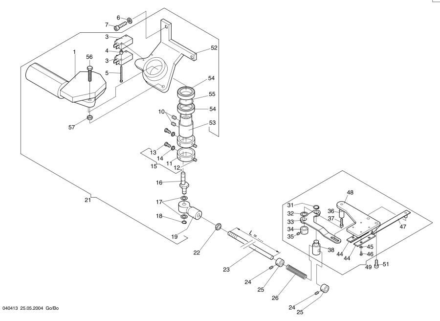
Flachbettstickmaschine SCF Baugruppe: Catching device - Fangeinrichtung
