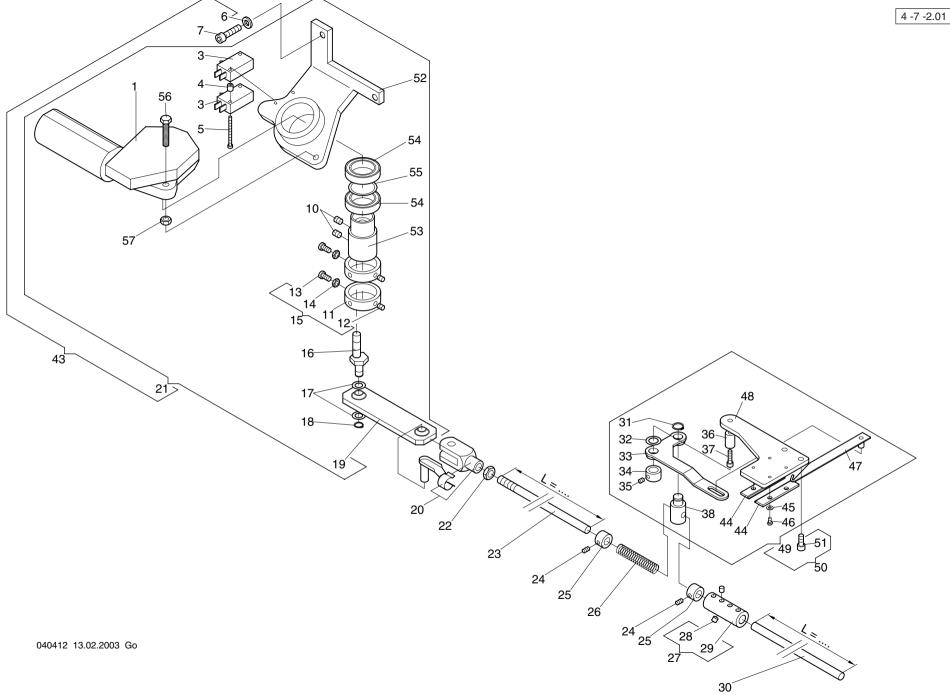
Baugruppe: Catching device - Fangeinrichtung Flachbettstickmaschine SCF
