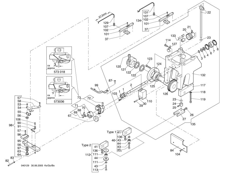
Baugruppe: Base plate with thread trimmer - Fußplatte mit Fadenschneider Flachbettstickmaschine SCF
