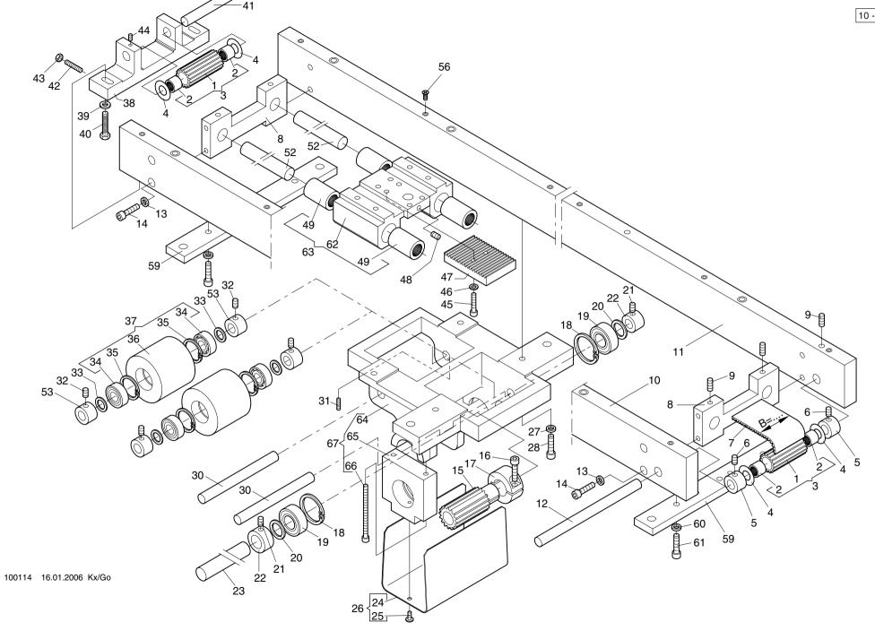
Flachbettstickmaschine SCF Baugruppe: Pantograph drive for side movement - Pantograph-Antrieb für Seite
