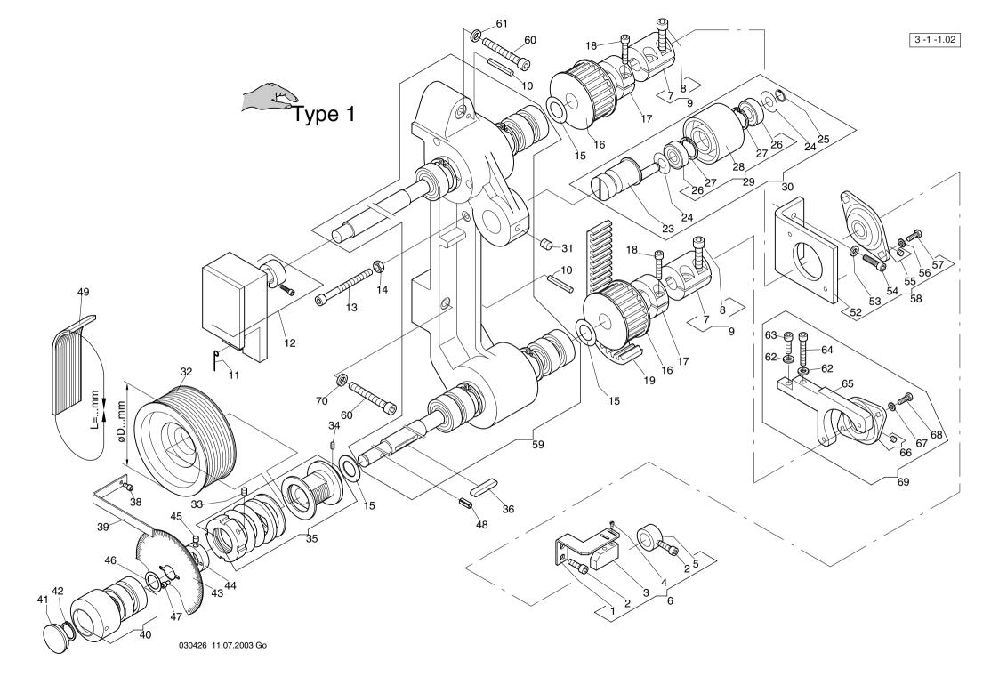
Flachbettstickmaschine SCF Baugruppe: Driving shaft above/below type 1 - Antriebswelle oben/unten Typ 1
