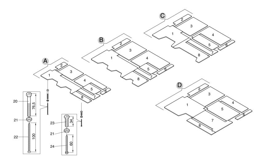
Maschinentype: Flachbettstickmaschine SCF Baugruppe: Work table - Tischplatten
