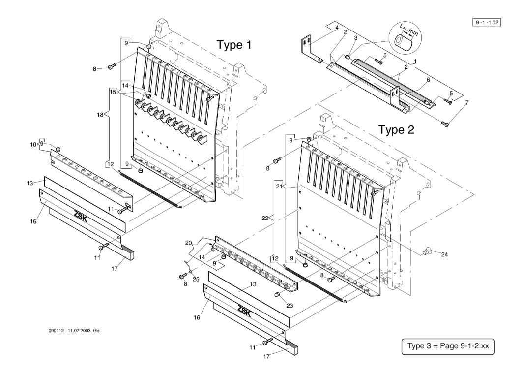
Flachbettstickmaschine SCF Baugruppe: Front panel type 1 and 2 - Stirnblech Typ 1 und 2
