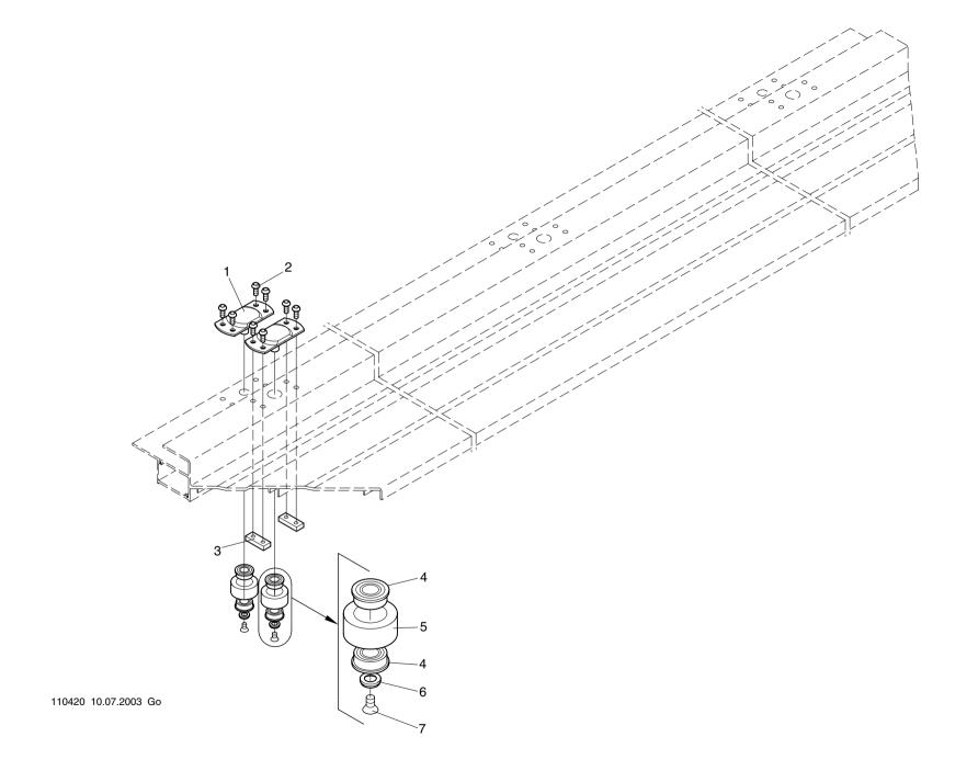
Baugruppe: Roller unit (depth) - Rolleneinheit (Tiefe) Flachbettstickmaschine SCF
