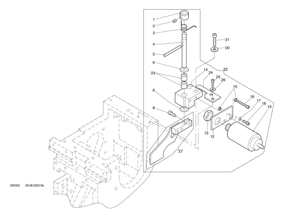
Baugruppe: Thread take up switch-off device - Fadengeberabschaltung Flachbettstickmaschine SCF
