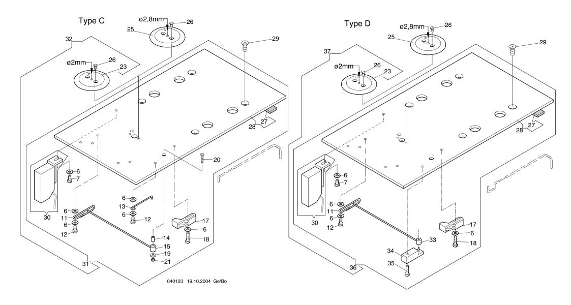
Flachbettstickmaschine SCF Baugruppe: Needle plate with bobbin thread monitor type C+D - Stichplatte mit Unterfadenwächter Typ C+D
