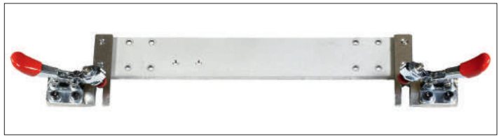
Abb. 11: Horizontal-Spanner montiert, Schlitten (Ansicht von oben)
