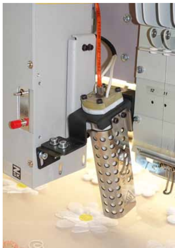
Устройство по термообработки аппликаций Hot Air Cutting Device
