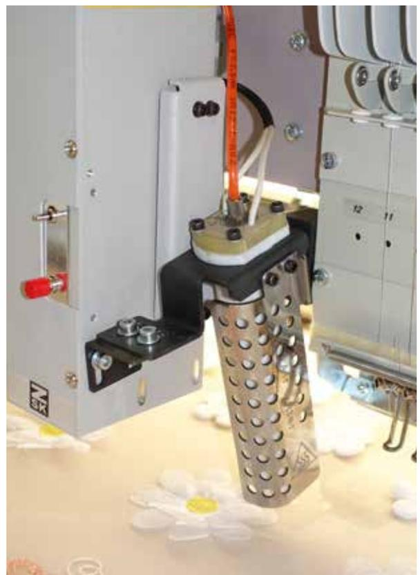
Устройство по термообработки аппликаций
